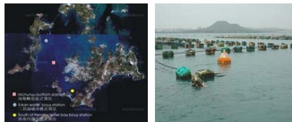
圖 1 左圖：澎湖二坎(淺藍)與澎南(黃色)內海附近箱網養殖區 WSN 浮標測站位置。粉紅色方塊為海墘嶼底碇式測站位置。右圖：澎南內海 WSN 浮標設置
