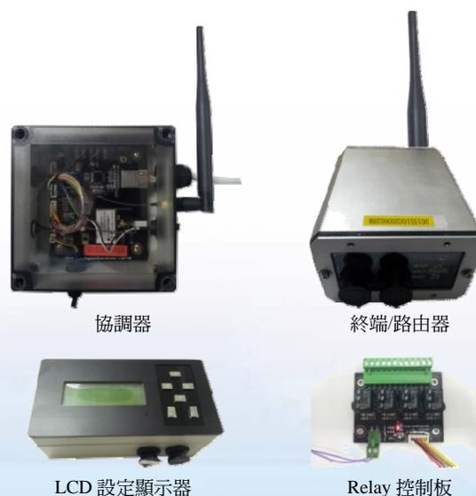
圖 3 Zigbee 養殖微氣候與水質監測系統之 4 種硬體設計
