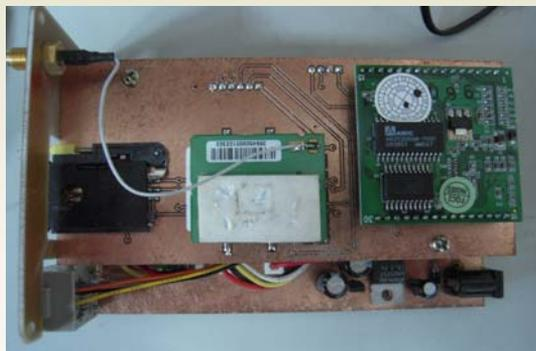
圖 3 GPRS/藍牙/區網控制及傳輸模組
