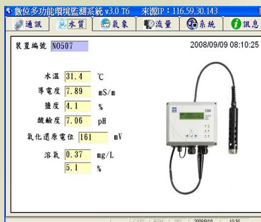
圖 5 YSI-5200 水質儀資料傳輸畫面
