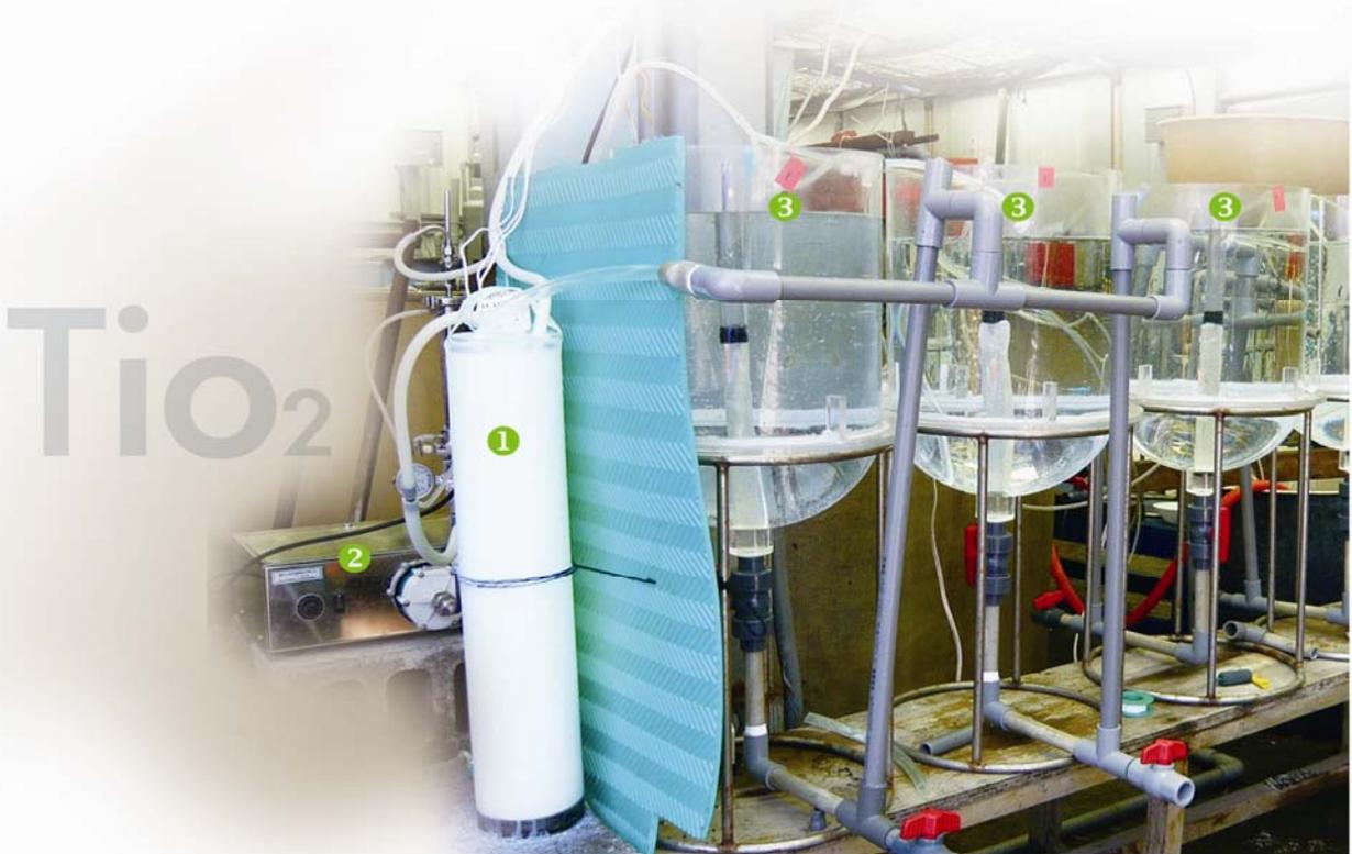
1：二氧化鈦光觸媒反應槽；2：掃流式微過濾器；3：孵育槽
