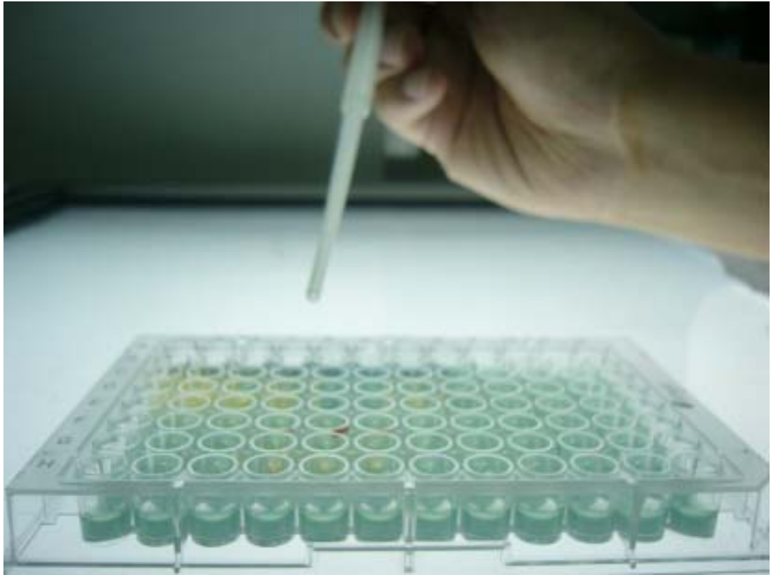
圖三 檢測水中病原菌的方法：加一滴養殖池水於本套組培養槽即可
