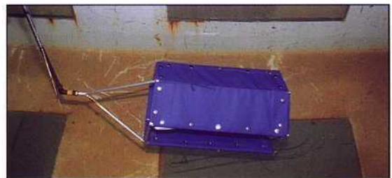
照片5 六邊形浮魚礁體在環流水槽之水中之攻角為0°時與支持棒連結之情形
