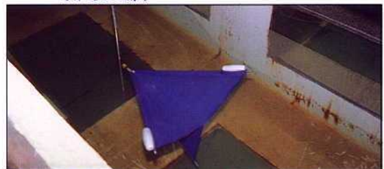
照片6 三角錐形浮魚礁體在水中攻角0°時之情形
