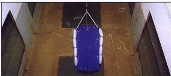
照片3 將三分力計橫向固定於水槽上方之昇降桿上，下方藍色部份為六邊形浮魚礁體
