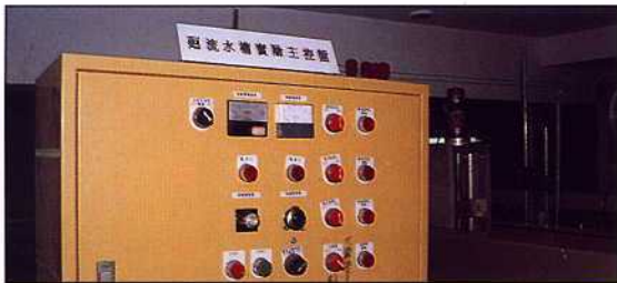
照片1 在成大造船系之環流水槽中控制流速之主控盤
