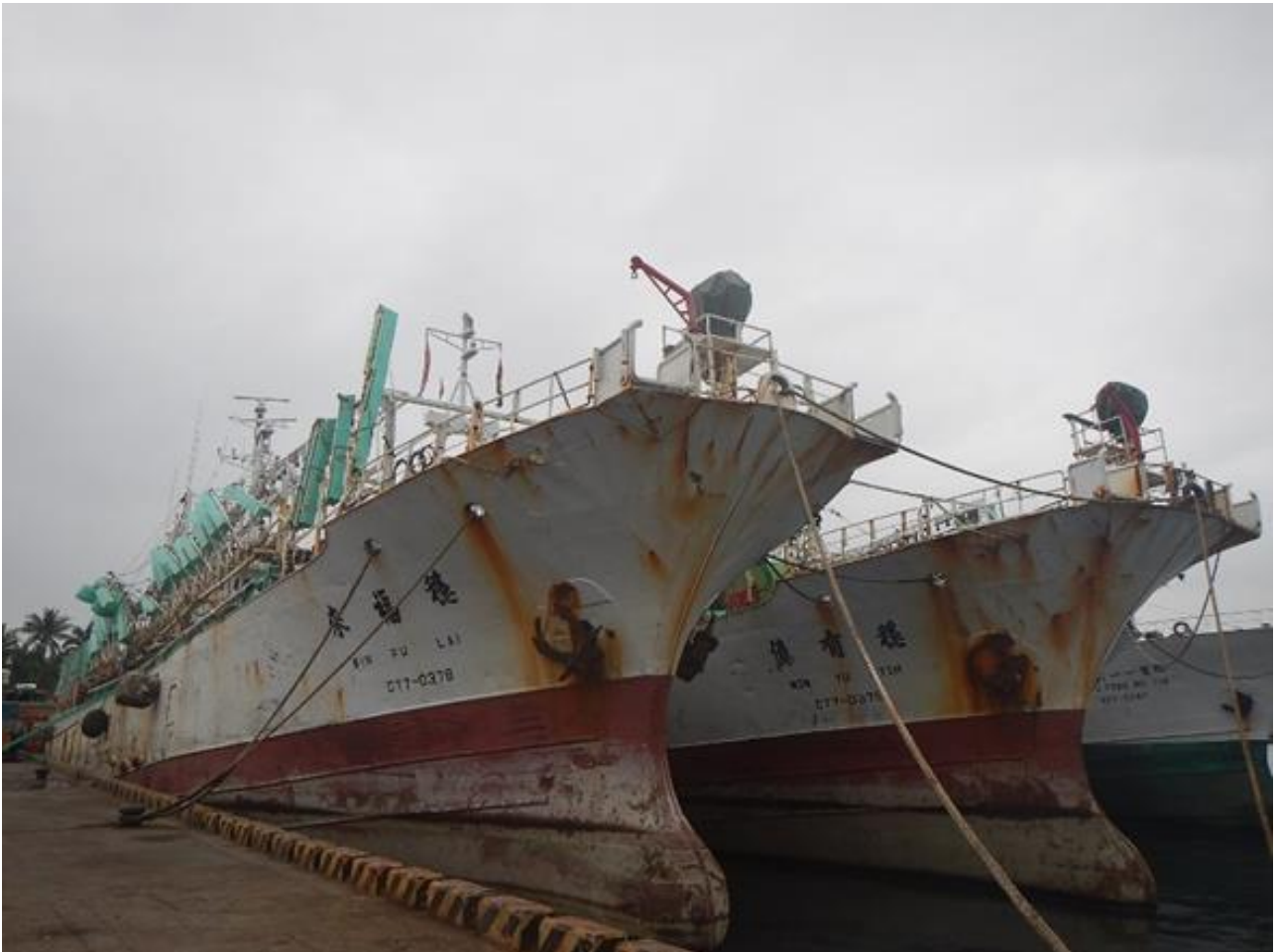
圖 1. 臺灣秋刀魚棒受網漁船，700 噸，船長 66 公尺，乘組員 60 人
