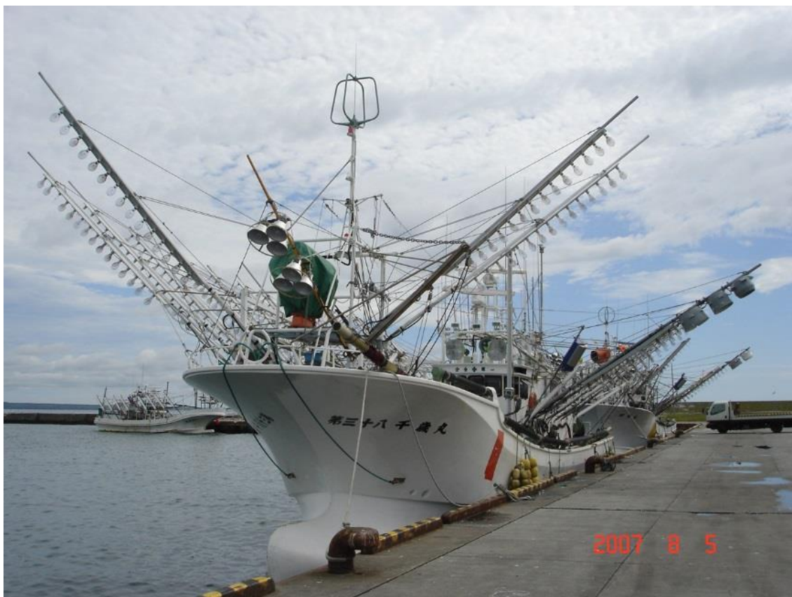
圖 3. 日本秋刀魚棒受網漁船，19 噸，船長 18.7 公尺，乘組員 6 人
