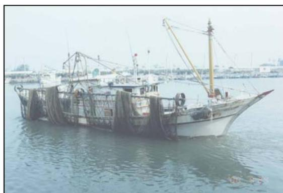
圖 3 一般船型蝦桁拖網
