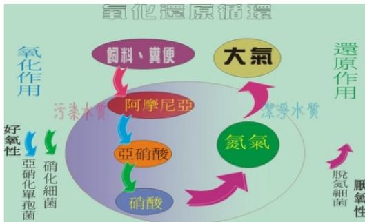
圖 2 傳統氧化還原的過濾流程，先從物理性過濾讓硝化細菌經氧化作用分解成硝酸後再經過厭氧性脫氮細菌的還原作用後讓將氮氣排出
