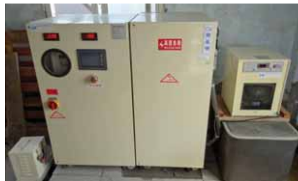
圖 4-9 本中心使用的三種消毒設備。左上：紫外線殺菌器；右上：海水電解器；下：臭氧殺菌器
