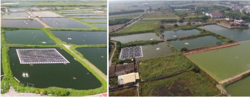
圖 3-1-1 浮筏型太陽光電設施結合白蝦養殖試驗
