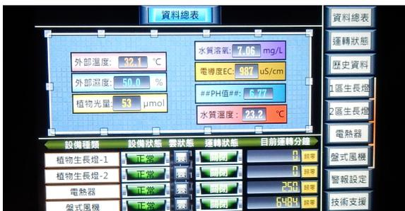
圖 2 自動監控系統主機畫面
