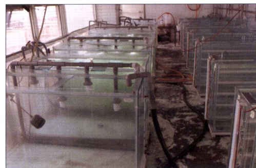
圖 4 藻類培養輔助光源燈具裝置於兩槽間兩槽可共用而充份利用空間
