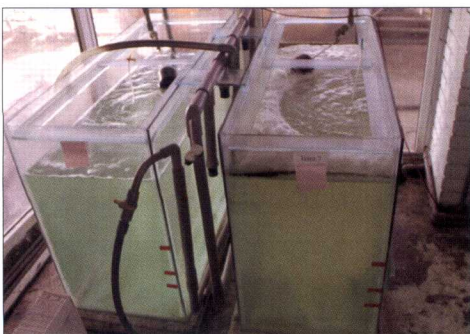
圖 2 300 公升培養槽使用浮球液位控制閥注入滅菌水至固定水位自動關閉
