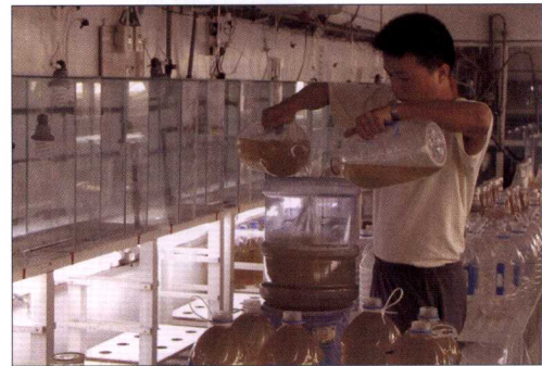
圖 3 保特瓶內之藻水可直接倒入互相連通輸送管線注入樓下之特定培養槽以簡化流程
