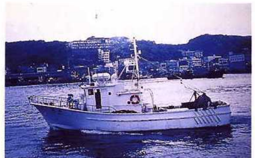
▼ 海鴻號試驗船26噸、180馬力 沿岸多用途漁業試驗船
