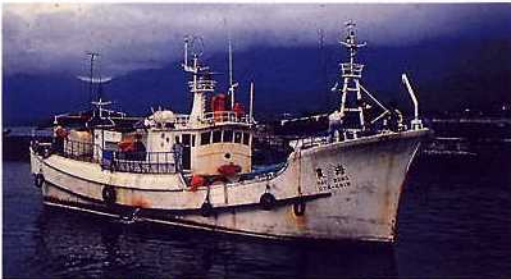
▲ 海農號試驗船53.6噸、440馬力 延繩釣兼近海多用途試驗船
