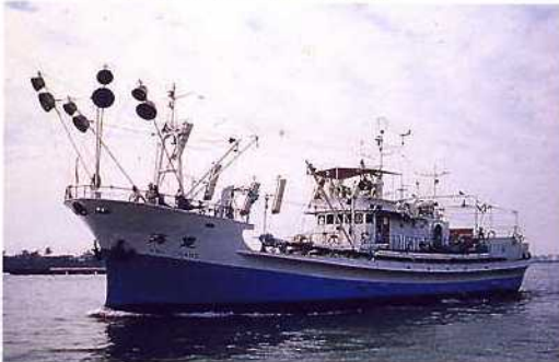
▼ 海建號試驗船 150噸、800馬力 流網兼近海多用途試驗船
