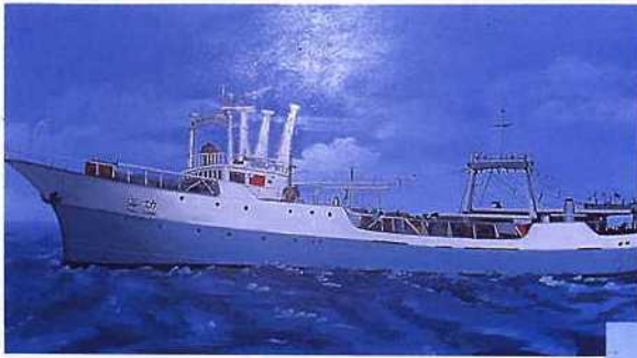
▼ 海建號試驗船 150噸、800馬力 流網兼近海多用途試驗船
