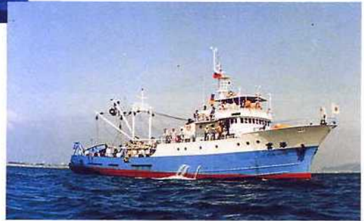
▼ 海鴻號試驗船26噸、180馬力 沿岸多用途漁業試驗船
