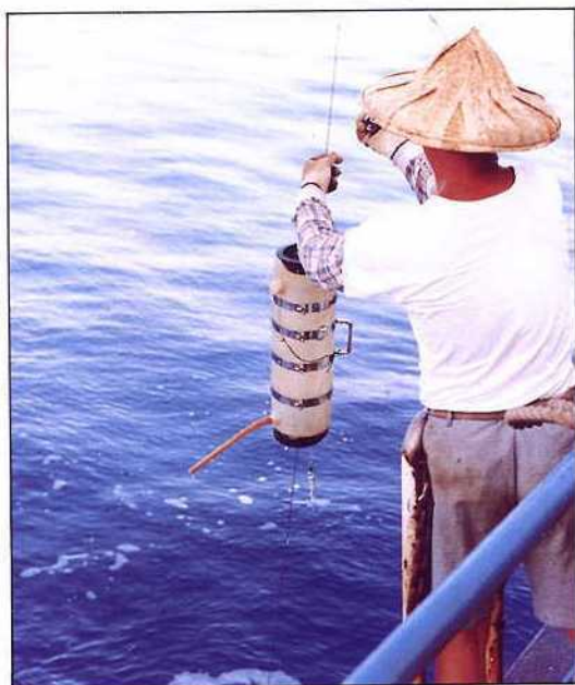
以Van Dorn 採水瓶採取海水，做營養鹽及葉綠素甲分析
