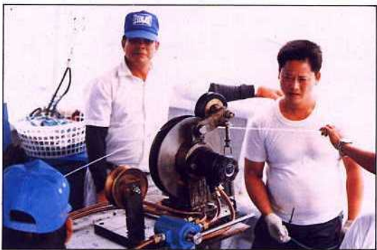
圖5 投繩作業及自動掛夾掛支繩實景圖
