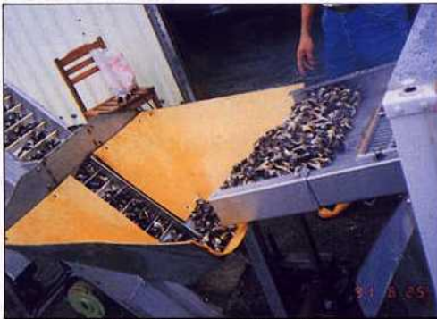
文蛤由清洗機滑入供料槽，輸送帶之流程
