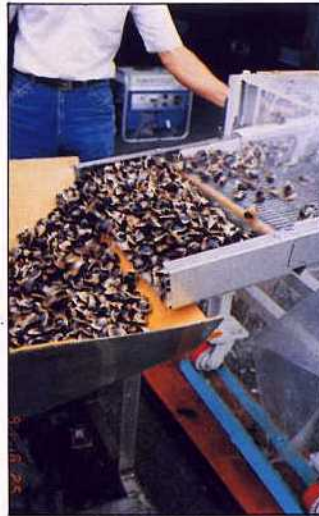
文蛤清洗後從清洗篩盤滑入供料機之料槽
