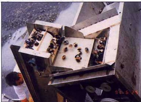
文蛤從供料機供料皮帶端落入分級機入料槽
