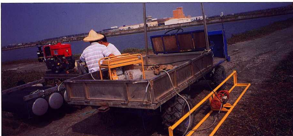
牽引第 2 代收穫機之引擎架座下坡道所使用之絞鋼索馬達與由貨車所固定之架座
