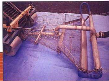
第1代收穫機之橫向下噴主管及第1、2、3層後噴管、輸送機入口之配置
