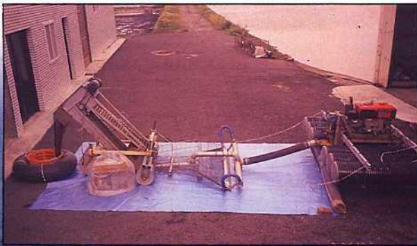
第1代收穫機之主元件：引擎泵浦、噴管集給網、刮板式輸送機之整體配置
