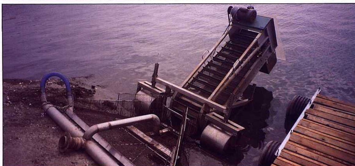
第 2 代收穫機所使用之改良式噴管集蛤網、第 2 層後噴管即可銜接輸送機入料金屬軟網
