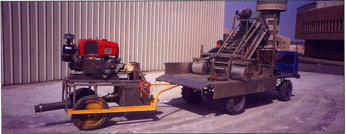
第2代收穫機之23馬力引擎泵浦由三輪板車承載，拆下轉向輪可由貨車在路面拖曳
