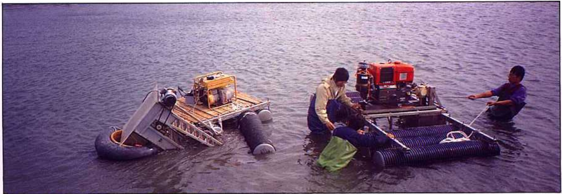
第2代收穫機在養殖池中由3人推拖拉曳收穫測試實況
