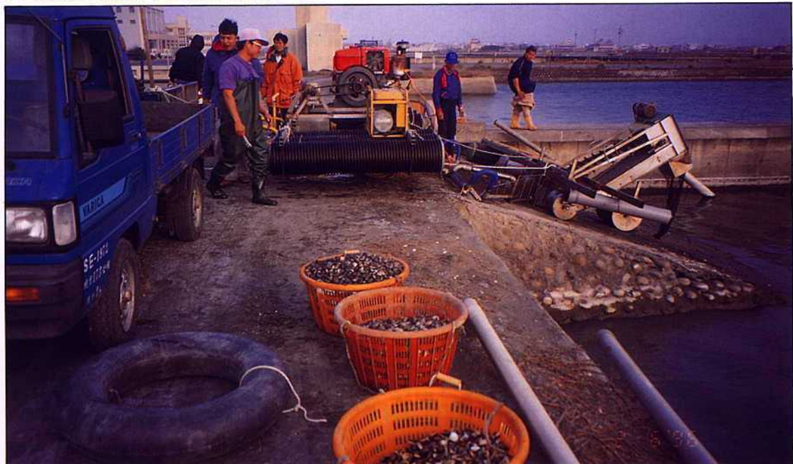
第2代收穫機完成測試由絞鋼索馬達牽引上坡道準備拆卸及所收穫之文蛤實況
