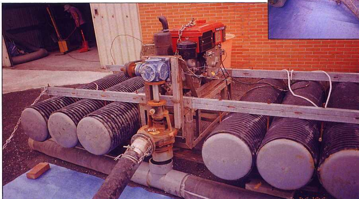
第1代收穫機之18馬力引擎、變向齒輪箱、泵浦、浮筒等各元件之配置
