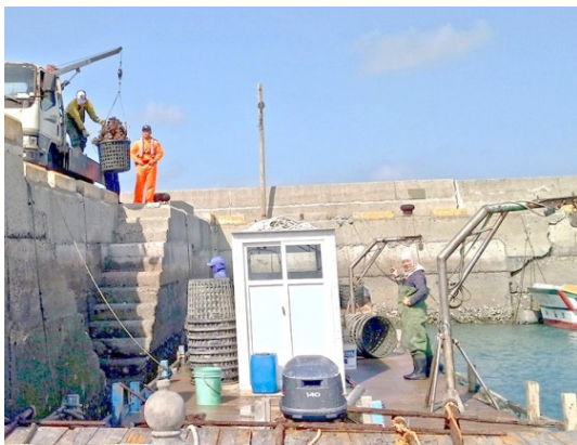
圖 8 竹筏與卡車都裝上吊臂，以提高工作效率
