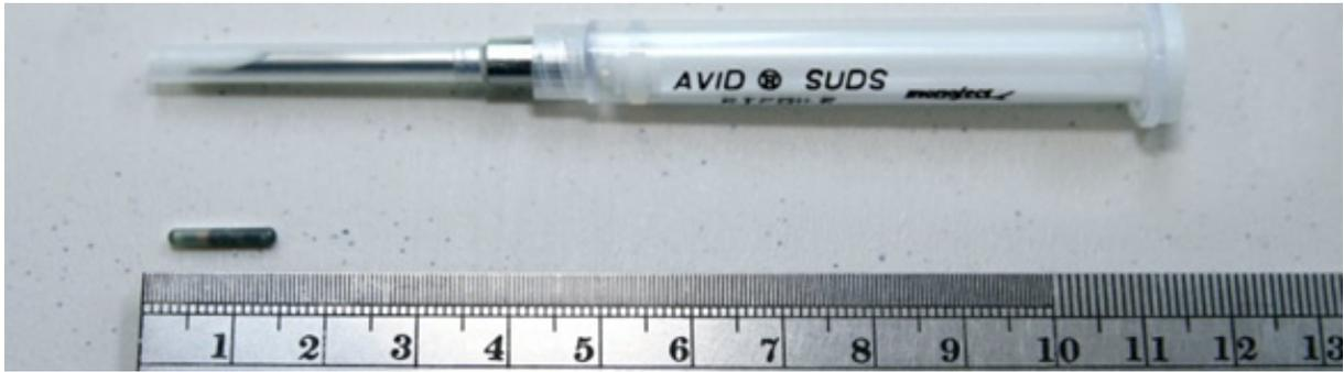
圖 2 微電子晶片外觀
