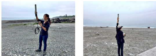
圖 1 衛星訊號接收器使用時需選擇無遮蔽物處，並盡量高舉天線，增加搜尋範圍
