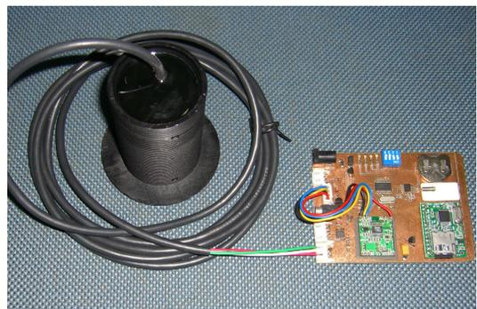
圖 4 中介控制晶片軟體電路板 (右側) 與微型數位聲納 (魚探) 模組核心元件 (左側) 之界接連動
