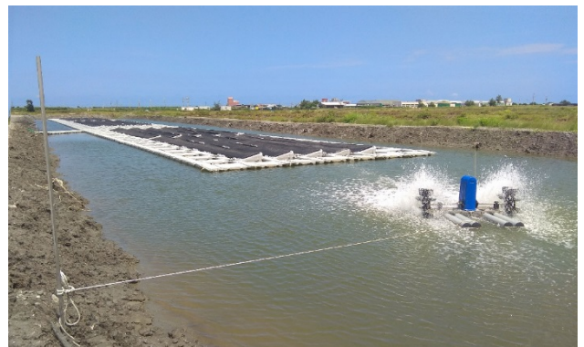
水試所與嘉義大學合作在海水繁養殖研究中心設置的模擬水面浮動型太陽光電設施之漁電共生試驗池。
